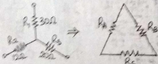
$$R_A = \frac{R_1 R_2 + R_2 R_3 + R_3 R_1}{R_1 + R_2 + R_3} = \frac{(30)(12) + (12)(20) + (20)(30)}{60} = 20\Omega$$
